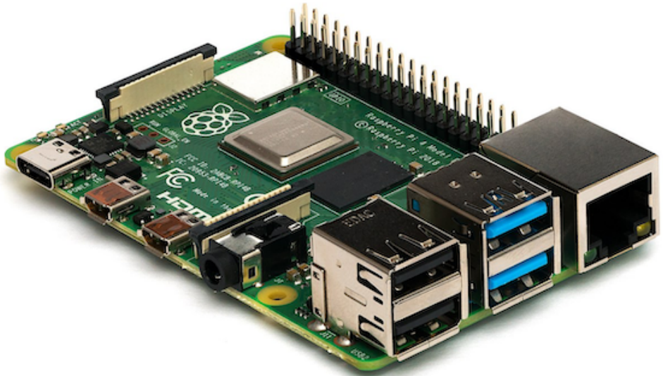
Figura 1.5. Raspberry Pi 4 Model B. O chip cadrado brillante cara ao centro da placa, á dereita da frambuesa, é o microprocesador, un SoC Broadcom BCM2711, con catro núcleos ARM Cortex-A72. (De Michael Henzler / Wikimedia Commons, CC BY-SA 4.0).
