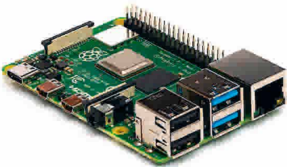
Figura 1.5. Raspberry Pi 4 Model B. El chip cuadrado brillante hacia el centro de la placa, a la derecha de la frambuesa, es el microprocesador, un SoC Broadcom BCM2711, con cuatro núcleos ARM Cortex-A72. (De Michael Henzler / Wikimedia Commons, CC BY-SA 4.0).
