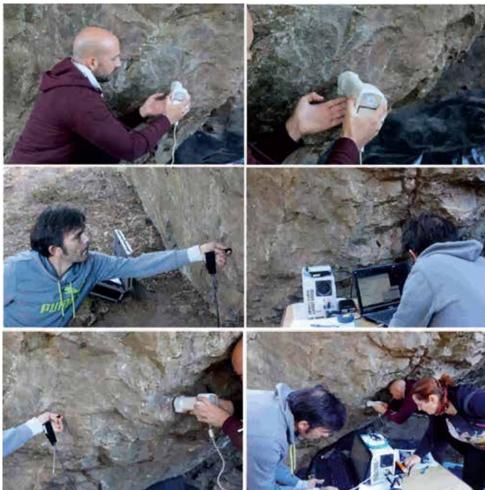
Fig. 21 Caracterización composicional e textural da rocha e da pintura in situ. Medición da cor mediante espectrofotometría e toma de espectros Raman.
