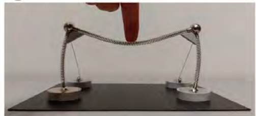
Figura 2-69. a) Pórtico cos nodos ríxidos e bases articuladas, sen carga aplicada. b) Deformación do pórtico cando se lle aplica unha carga vertical na viga horizontal
