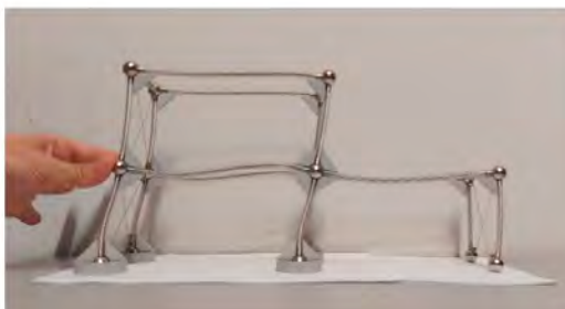
Figura 2-24. Estrutura translacional de orde 3: 1ª translación (a) permitida, (b) impedida
