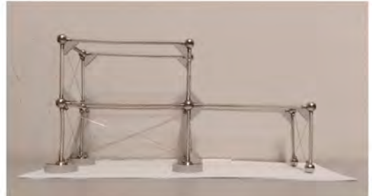
Figura 2-24. Estrutura translacional de orde 3: 1ª translación (a) permitida, (b) impedida
