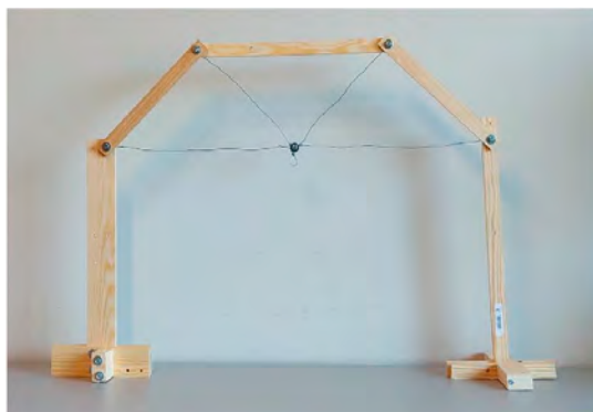
Figura A-15.3 Exemplos de maqueta da celosía de barras do exercicio, cas barras a compresión feitas en madeira e as de tracción con cables.
