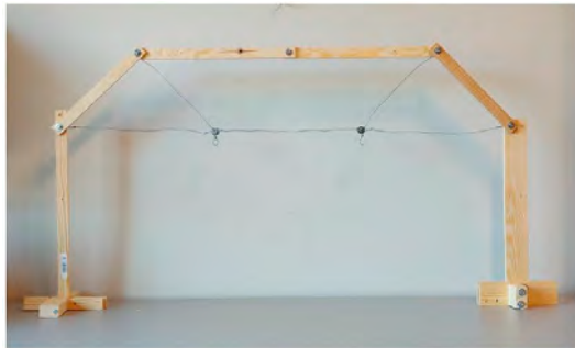
Figura A-14.3 Exemplos de maqueta de celosía de barras cas barras a compresión feitas en madeira e as de tracción con cables.
