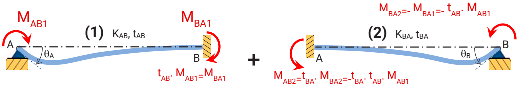
Figura 2-13. Descomposición en (1) e (2) de (0) en aplicación do principio de superposición
