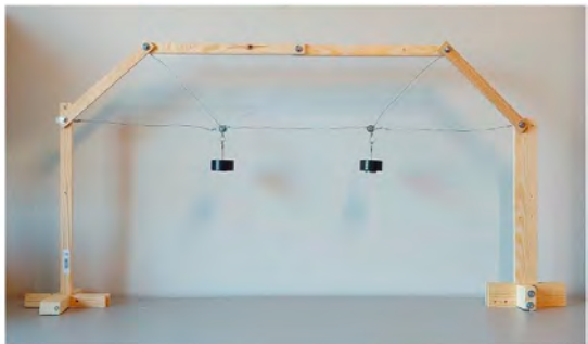
Figura A-14.3 Exemplos de maqueta de celosía de barras cas barras a compresión feitas en madeira e as de tracción con cables.
