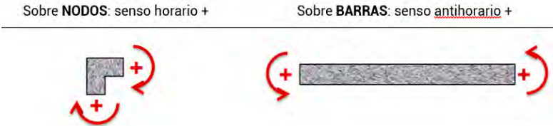
Figura 2-36. Sentido positivo dos momentos flexores en nodos (esquerda) en barras (dereita) segundo criterio do método de Cross
