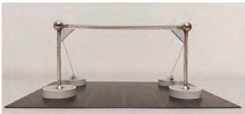
Figura 2-69. a) Pórtico cos nodos ríxidos e bases articuladas, sen carga aplicada. b) Deformación do pórtico cando se lle aplica unha carga vertical na viga horizontal
