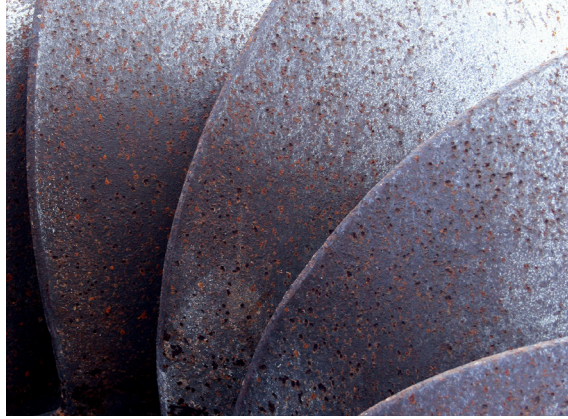
Figura 3.24: Resultado de la cavitación sobre un rodete.
