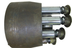
(f) Barrilete de una bomba de émbolos múltiples (máquina de desplazamiento positivo generadora alternativa).
