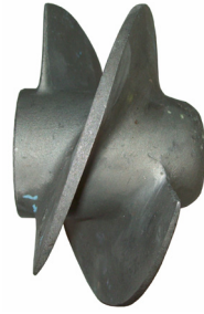
(b) Rodete de turbomáquina generadora (de flujo axial).
