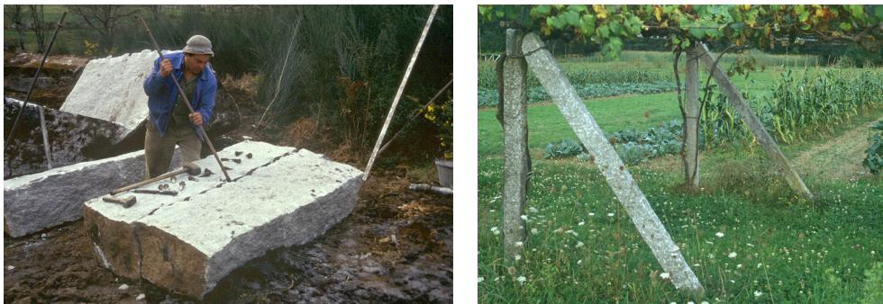
Figura 3.6. operación de dimensionamiento de un bloque de granito mediante técnicas manuales (cuñas y maza). A la derecha, perpiños obtenidos mediante corte manual de un granito, usados como postes de viña.
