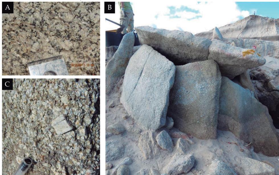
Figura 2.12. A) aspecto de la variedad actualmente comercializada como *Gris Perla* (superficie natural de afloramiento); B y C): el dolmen de Guidorio Areoso (B) está construido casi en su totalidad con la misma granodiorita que se explota como *Gris Perla*; la imagen C es un detalle de la granodiorita del dolmen, destacando los megacristales de feldespato potásico.
