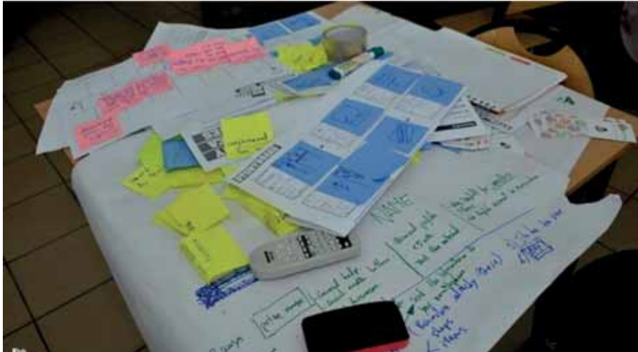
Figura 5.7: Prototipos de aplicacións informáticas. Trátase de prototipos en papel que poderíamos clasificar como de media fidelidade. A interactividade sópórtase movendo notas adhesivas de sitio cando alguén selecciona diversas funcións ilustradas no prototipo.
