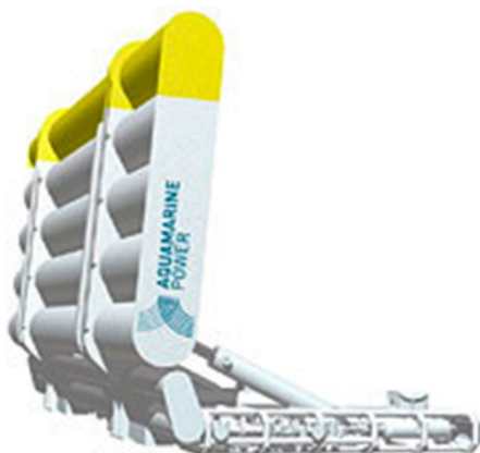
Figura 5.7 (a, b). Dispositivo de pa oscilante. Oyster desenvolvido por Aquamarine. Cortesía de Aquamarine Power ( www.aquamarine.com ). Imaxe obtida de tethys-engineering.pnnl.gov/technology/oscillating-wave-surge
