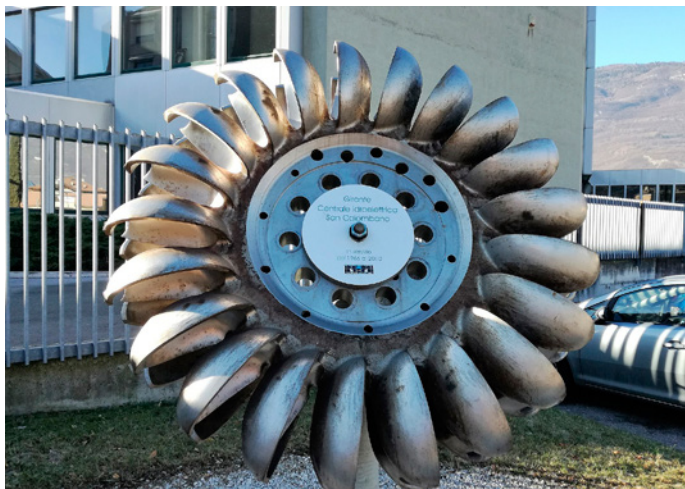
Figura 4.5. Exemplo de turbina Pelton. Imaxe obtida de commons.wikimedia.org/wiki/ , baixo a licenza Creative Commons Attribution-Share Alike 4.0 International
